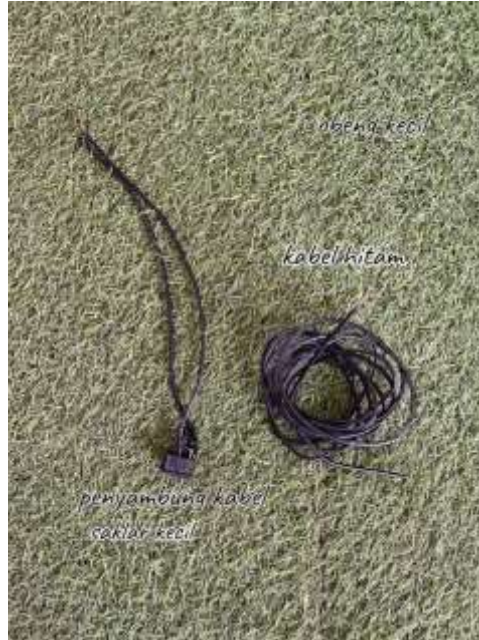
Gambar 3.Kabel dan Saklar kecil
